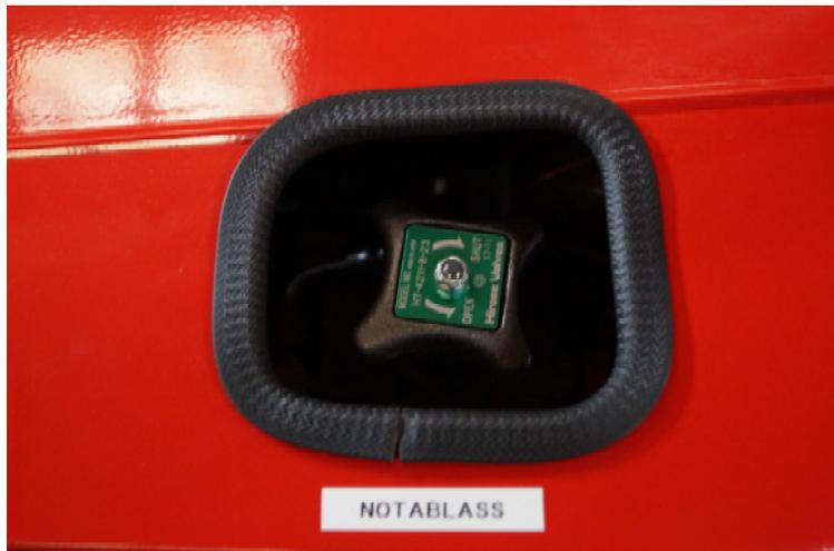
Ist der Bediener der Hubarbeitsbühne nicht mehr in der Lage den Korb selbständig abzusenken, können Sie den Korb mit Hilfe des Notablassventils absenken.
